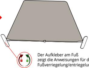
Der Aufkleber am Fuß zeigt die Anweisungen für die Fußverriegelung/entriegelung
